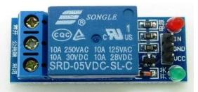
Fig.2. Relay Module
